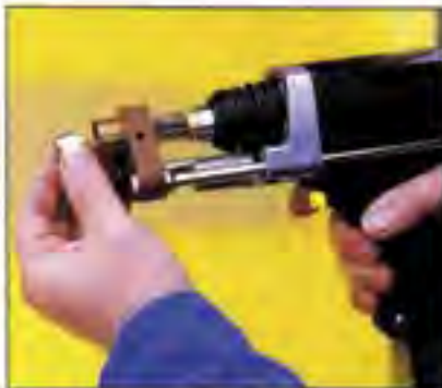
Insert Abrasion Resistant Stud
